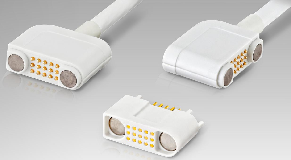
MultiMag15 ist eine Hybrid-Steckverbindung mit 15 Kontakten. Versorgungsspannung und -strom, Gigabit-Ethernet und mehrere Steuersignale können damit gleichzeitig übertragen werden.
